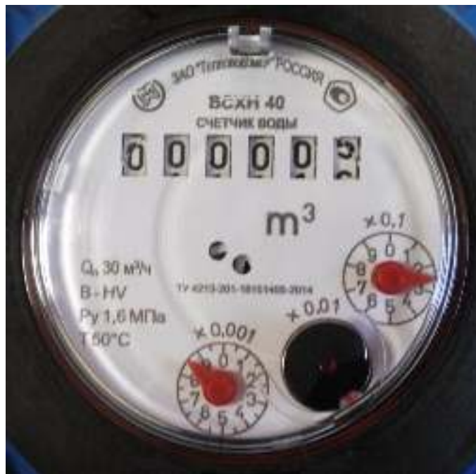
Рисунок 1. Пример снятия показаний со счётчика воды.
